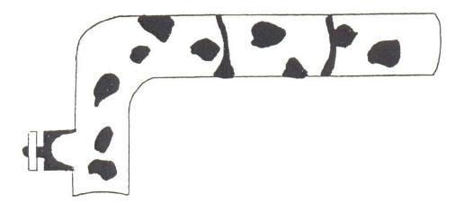
FIGURE 19-2 REPRESENTATION OF 25% LOCALIZED DAMAGE
